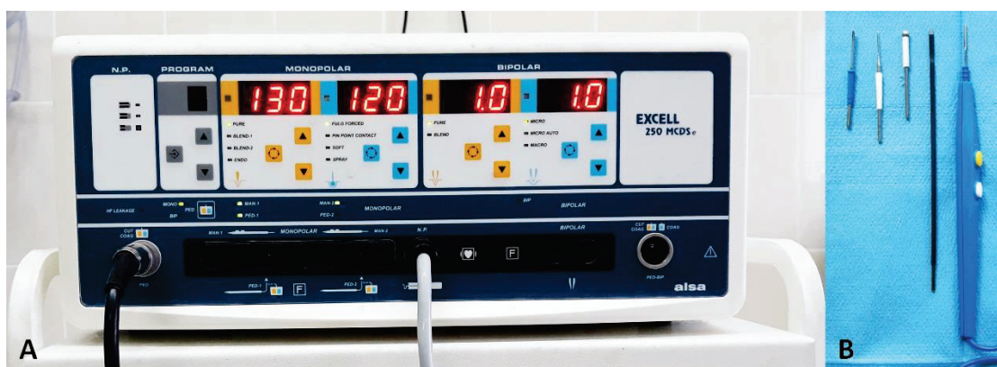
Рис.28. Электрохирургическое оборудование для осуществления диатермокоагуляции во время операции: А. Электрохирургический блок питания, обеспечивающий два режима воздействия на ткани; В. Одноразовая пластмассовая ручка с присоединяемыми насадками различной формы и длины.
